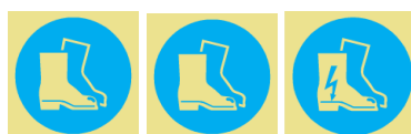
Figura 1 – Diferentes tipos de sinalização sobre a obrigatoriedade do uso de calçado de segurança
